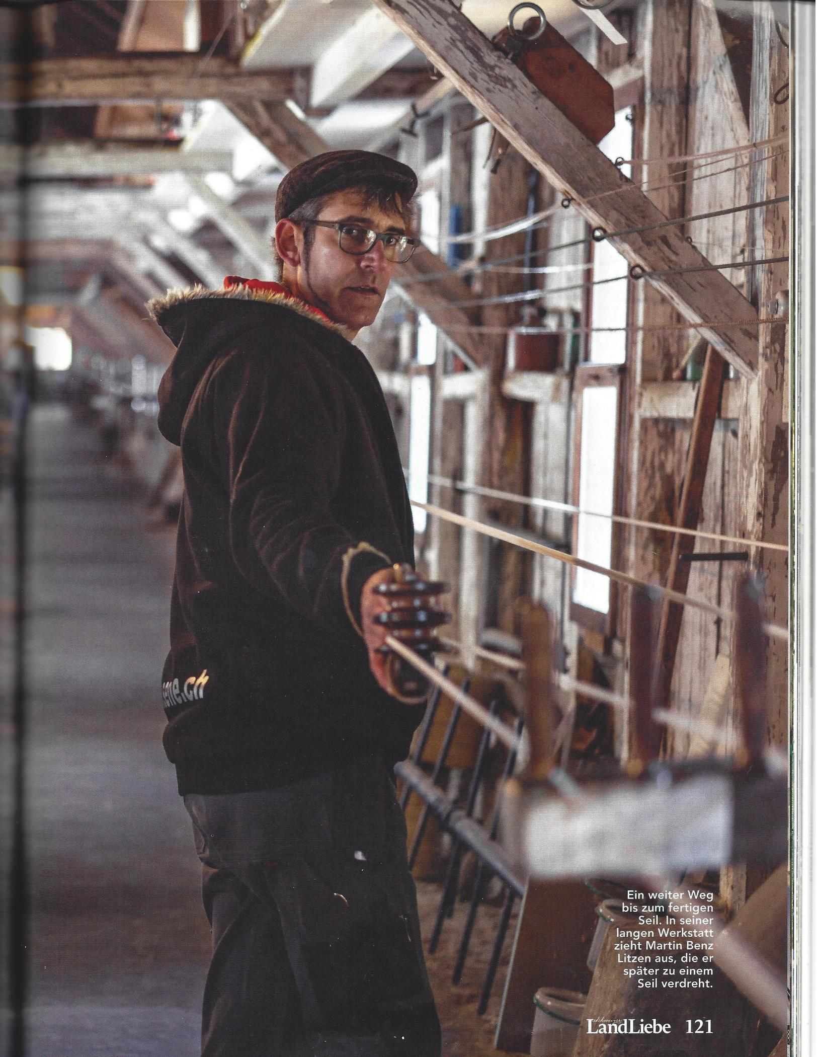
Ein weiter Weg bis zum fertigen Seil. In seiner langen Werkstatt zieht Martin Benz Litzen aus, die er später zu einem Seil verdreht.
